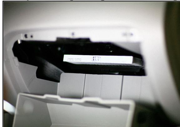
Воздушный фильтр кондиционера расположен позади перчаточного ящика. Он позволяет удалить из поступающего воздуха пыль и выхлопные газы. Если интенсивность потока воздуха резко снижается без видимых причин, обратитесь на станцию техобслуживания и замените воздушный фильтр.
