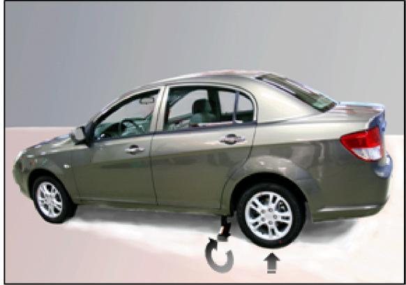
3. Поворачивая рукоятку домкрата по часовой стрелке, приподнимите колесо на 3-5 см от поверхности земли.
