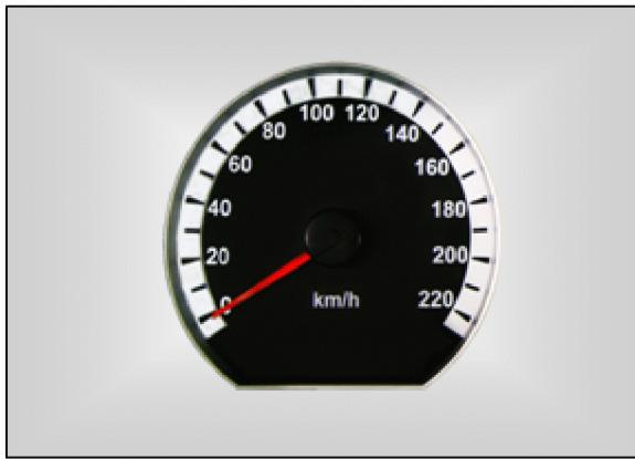
Спидометр показывает скорость движения автомобиля в километрах в час (км/ч).
