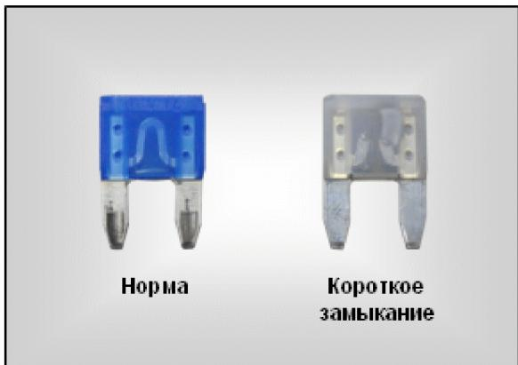
Блоки предохранителей, обеспечивающих работу электрооборудования автомобиля, установлены в салоне и в двигательном отделении. При выходе из строя электрического прибора проверьте состояние соответствующего предохранителя и при необходимости замените его. Замена предохранителей выполняется в следующем порядке:
