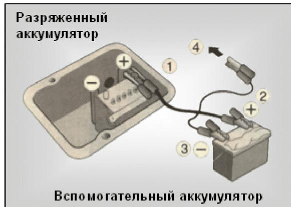
Если аккумулятор разряжен, можно запустить двигатель от внешнего аккумулятора.
