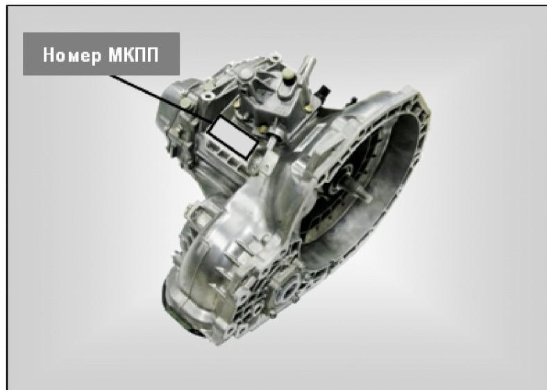
Номер МКПП состоит из 11 символов и располагается на верхней части корпуса МКПП.
