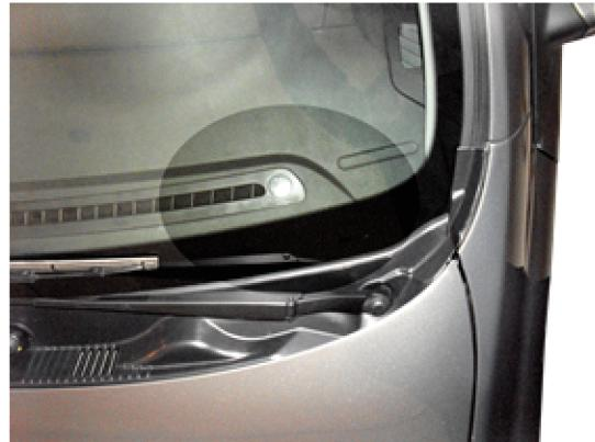
Солнечный датчик расположен перед вентиляционными отверстиями, предназначенными для обогрева ветрового стекла. Датчик определяет интенсивность солнечного света при работе системы в автоматическом режиме.
