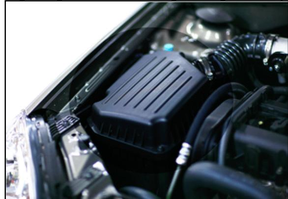
Воздухоочиститель удаляет загрязнения из поступающего в двигатель воздуха. Засор фильтра воздухоочистителя снижает срок службы двигателя и его мощность, а также повышает содержание вредных веществ в выхлопных газах.
