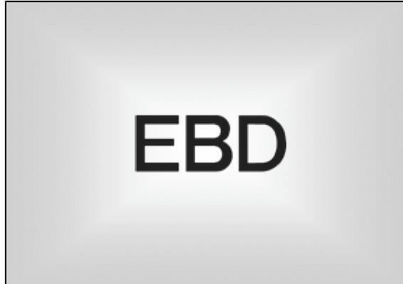
Индикатор загорается одновременно с индикаторами тормозной системы и АБС. При резком торможении автомобиль может занести из-за того, что тормозное усилие неравномерно распределяется между передними и задними колесами. Если индикатор EBD загорается во время движения, старайтесь не набирать высокую скорость и избегайте резких поворотов. Обратитесь на станцию техобслуживания, чтобы проверить систему и устранить имеющиеся неполадки.
