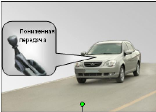
Длительное нажатие на педаль тормоза во время спуска по склону может привести к перегреву тормозов и снижению эффективности тормозной системы. Переведите рычаг переключения передач в положение пониженной передачи и используйте торможение двигателем наряду с торможением педалью.
