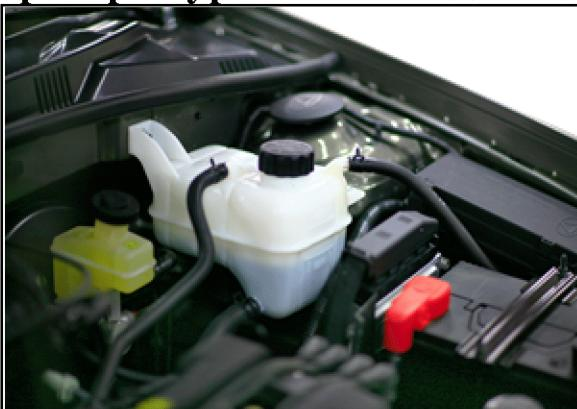
Не открывайте крышку бачка с охлаждающей жидкостью, пока двигатель не остынет.
