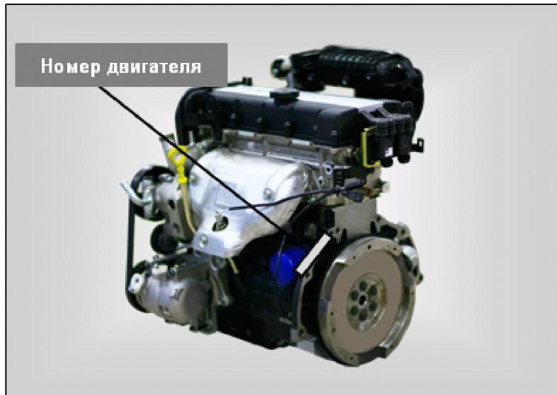
Номер двигателя состоит из 14 символов и располагается на блоке цилиндров. Он включает в себя название двигателя, год выпуска, серийный номер и страну производства двигателя.
