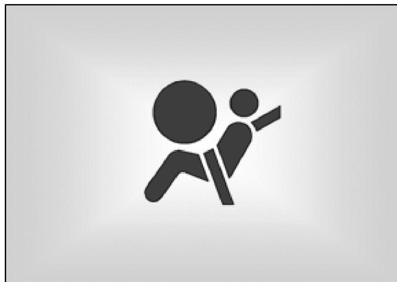
Модуль подушки безопасности включает в себя четыре элемента: датчик удара, блок управления, саму подушку безопасности и индикатор. При наличии неисправности в системе загорается индикатор, предупреждающий водителя о возникшей проблеме.
