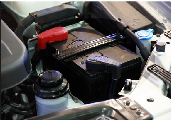
Регулярно проверяйте состояние и зарядку аккумулятора, чтобы избежать возможной порчи автомобиля и его отдельных узлов. Удаляйте загрязнения с аккумулятора, так как они снижают срок его службы. Максимально эффективная работа аккумулятора достигается при следующих условиях:
