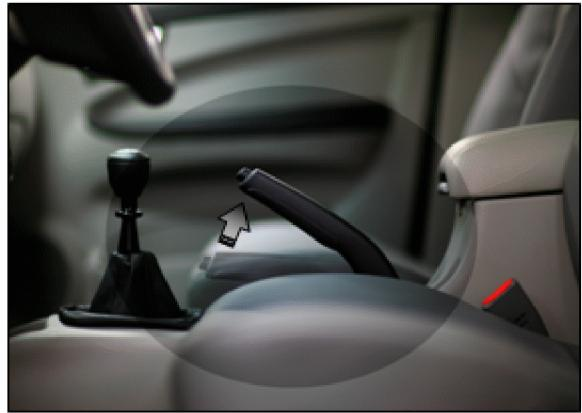
Во время технического осмотра автомобиля отрегулируйте ход рычага стояночного тормоза. Проверьте ход рычага, подсчитав количество щелчков при движении рычага с силой в 20 кг из положения полного отключения стояночного тормоза. Стандартное количество щелчков: 7-10. Если эффективность стояночного тормоза ухудшается (например, на подъеме), обратитесь на станцию техобслуживания вашего дилера.
