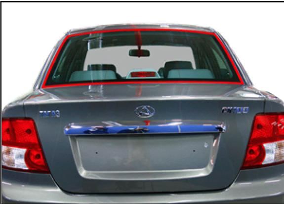
Антенна совмещена с обогревателем заднего стекла. Следите за тем, чтобы заднее стекло не было поцарапано, проверяйте целостность проводки обогревателя. Дефекты проводки могут повлиять на качество приема радиосигнала.
