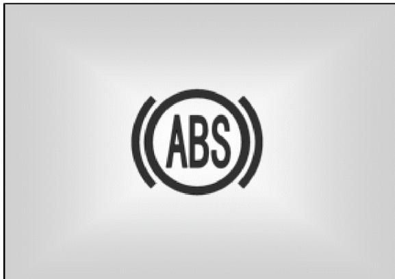
Индикатор АБС включается на короткое время после включения зажигания, чтобы подтвердить самодиагностику системы и проверить работу лампочки индикатора. Примерно через 3 секунды индикатор гаснет.
