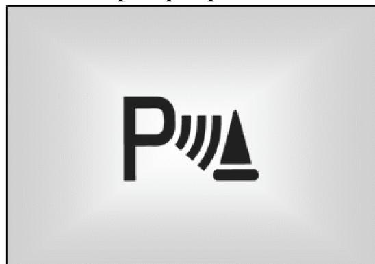
Парктроник – это вспомогательное устройство, сообщающее вам о наличии препятствий в непосредственной близости от автомобиля. Информация о препятствиях, расположенных в пределах 120 см от автомобиля, считывается датчиком парктроника.
