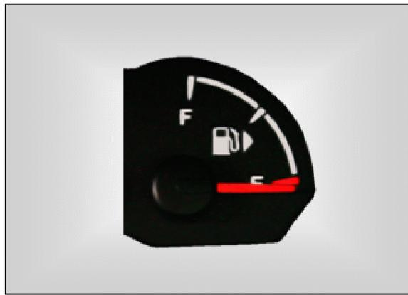
Датчик уровня топлива показывает, сколько топлива осталось в топливном баке (при включенном зажигании).
