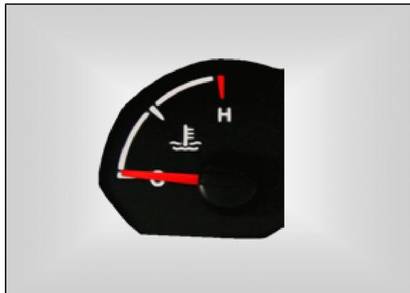
Датчик температуры показывает температуру охлаждающей жидкости двигателя (при включенном зажигании).
