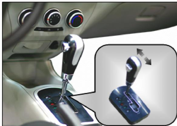
Автоматическая коробка переключения передач позволяет автоматически переключаться между 1 и 4 передачами с учетом скорости автомобиля, текущего положения рычага, положения педали акселератора.
