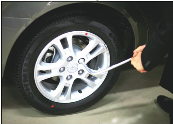
4. Полностью открутите гайки, снимите колесо.
