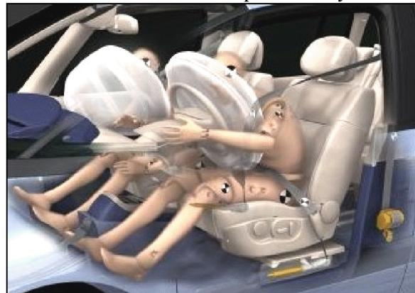
Водительская подушка безопасности расположена в рулевом колесе. При сильном лобовом столкновении она раскрывается и защищает от удара лицо и грудную клетку водителя. Подушка пассажира раскрывается одновременно с водительской и защищает пассажира, сидящего на переднем сиденье.
